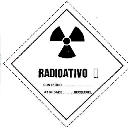
Figura D.1 - Material radioativo - (Categorial)
